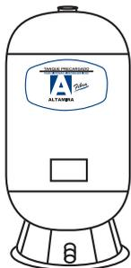
1.- ALTAMIRA FIBRA tiene una cámara de aire sellada que es presurizada antes de salir de la fábrica. El aire y el agua nunca entran en contacto entre sí, eliminándose cualquier posibilidad de "anegamiento" a causa de la pérdida de aire hacia el sistema de agua.
